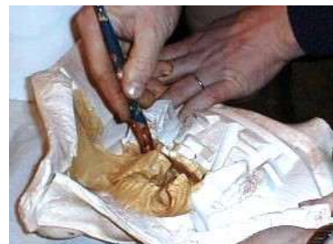
Appliquer de l'Acrystal Decor Carrara sur le moule afin d'éviter les bulles de surface
